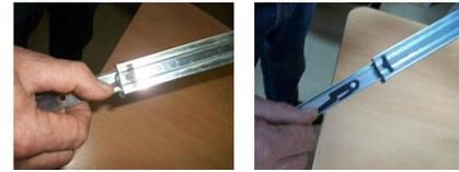
**Разбор шариковых направляющих.** Для того чтобы их рассоединить необходимо нажать на фиксатор, как показано на фотографии. При помощи тех же фиксаторов ящик вытягивается из готового изделия. При этом фиксатор с одной стороны нажимается вниз, а с другой вверх.
